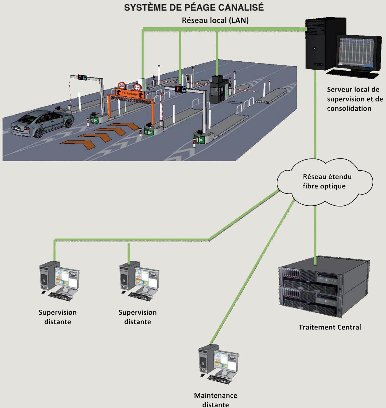
Dotés chacun d'une unité centrale, les terminaux de paiement informatiques au niveau de l'utilisateur assurent le pilotage des automatismes de gestion de la circulation (systèmes de détermination de classe de véhicule, signalisations, barrières, télépéages...)
